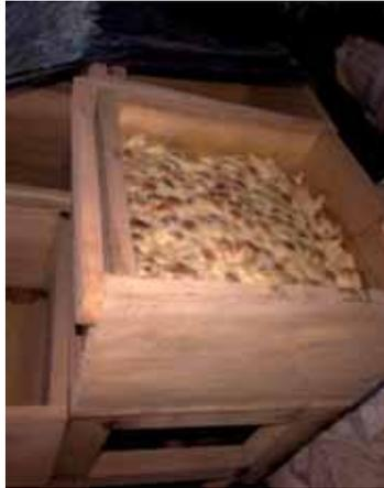
**Figura 5.2.** Fermentador en escalera empleado en los ensayos de campo con masas parcialmente despulpada (20-60 % pulpa) y con cien (100% de pulpa)
