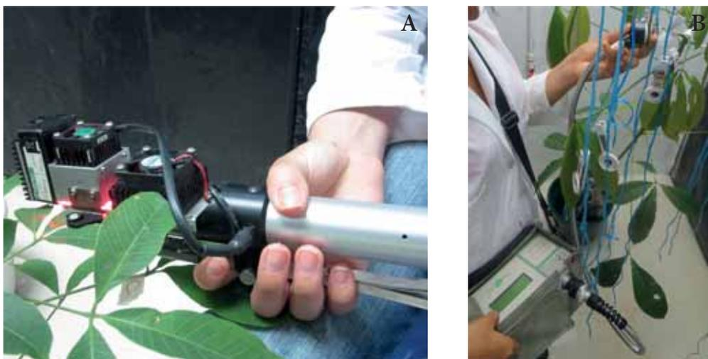
**Figura 4.2.** Evaluaciones fisiológicas en laboratorio. **A.** Intercambio gaseoso con un equipo portátil IRGA. **B.** Fluorescencia de la clorofila con fluorómetro portátil.
