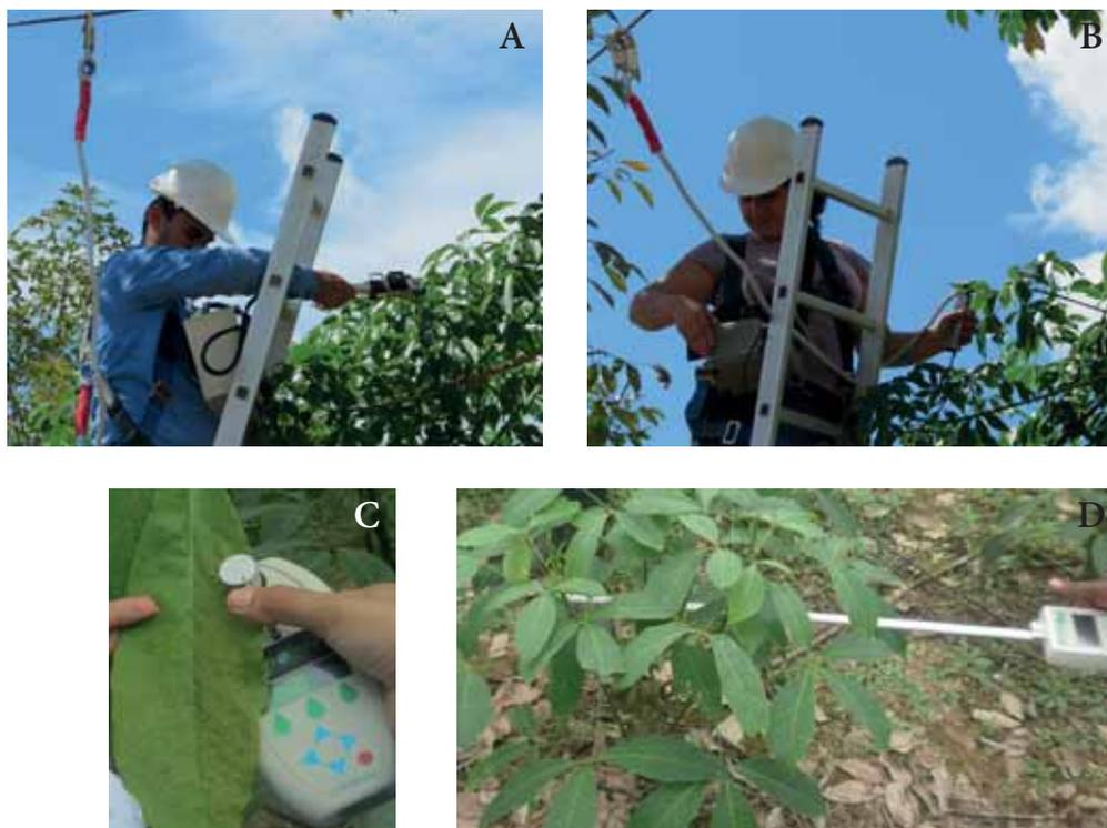
**Figura 4.4.** Evaluaciones ecofisiológicas en campo. **A.** Intercambio gaseoso con un equipo portátil IRGA. **B.** Fluorescencia de la clorofila con fluorómetro portátil. **C.** Concentración relativa de clorofila con medidor portátil. **D.** Índice de área foliar con ceptómetro.
